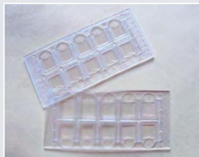
Alternative zu teuren und arbeitsaufwändigen Neubauer Zählkammern.
